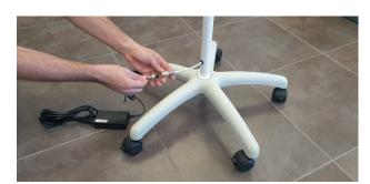
10. Schließen Sie das Netzkabel mit dem SCHU-KO-Stecker an das Stromnetz an.
